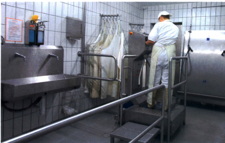
Hygieneschleusen sind die Basis einer guten Personalhygiene. Sie vermeiden die Übertragung von Kontaminationen in reine Produktionsbereiche.
