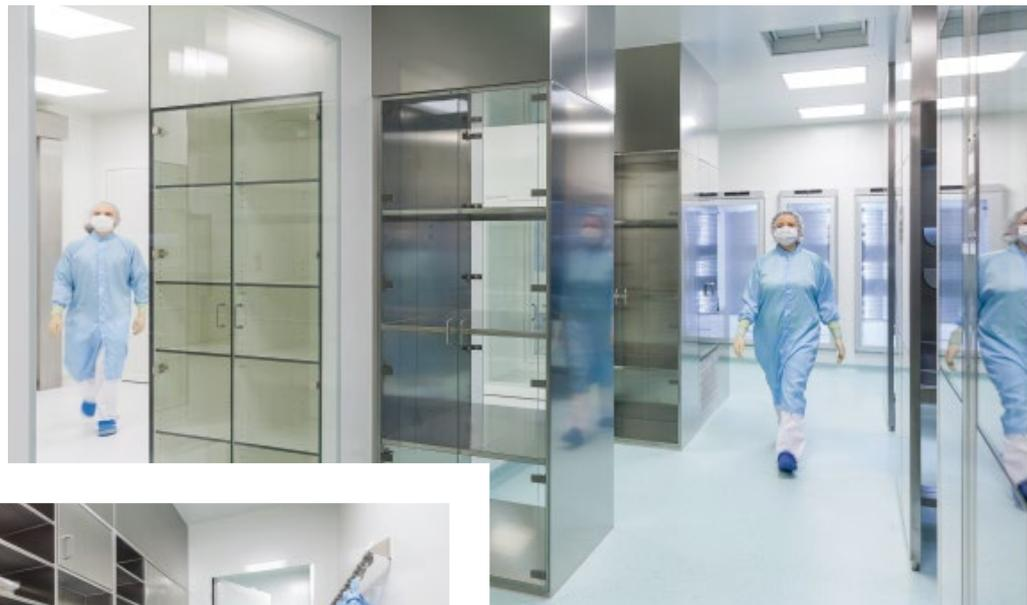
Abb. 4: Lagerschränke im FIFO-Prinzip mit beidseitig zu öffnenden Glastüren führen zu effizienteren Arbeitsabläufen
