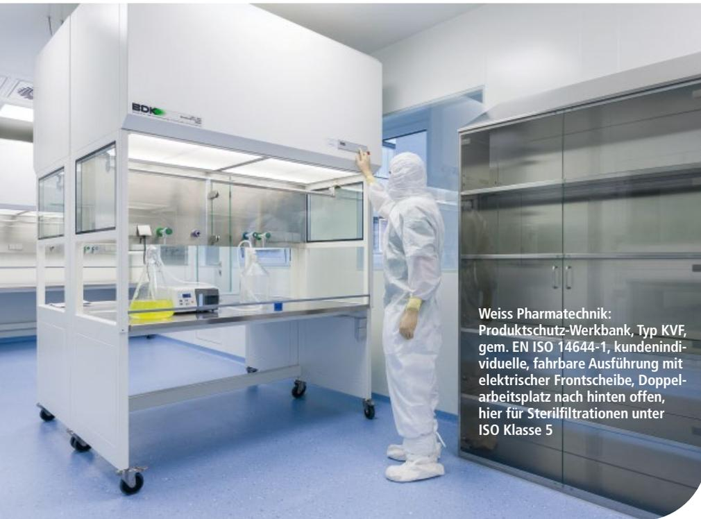
Weiss Pharmatechnik: Produktschutz-Werkbank, Typ KVF, gem. EN ISO 14644-1, kundenindividuelle, fahrbare Ausführung mit elektrischer Frontscheibe, Doppelarbeitsplatz nach hinten offen, hier für Sterilfiltrationen unter ISO Klasse 5
